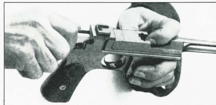
FIG. 15 — Nachuntendrücken des den Verschluss offenhaltenden Zubringers
