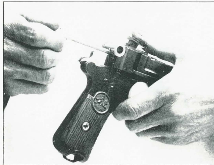
FIG. 24. — Einsetzen des Visierstückes.
