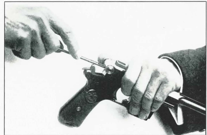
FIG. 20. — Zurückdrücken des Schlagbolzens zum Herausziehen des Griffbolzens.
